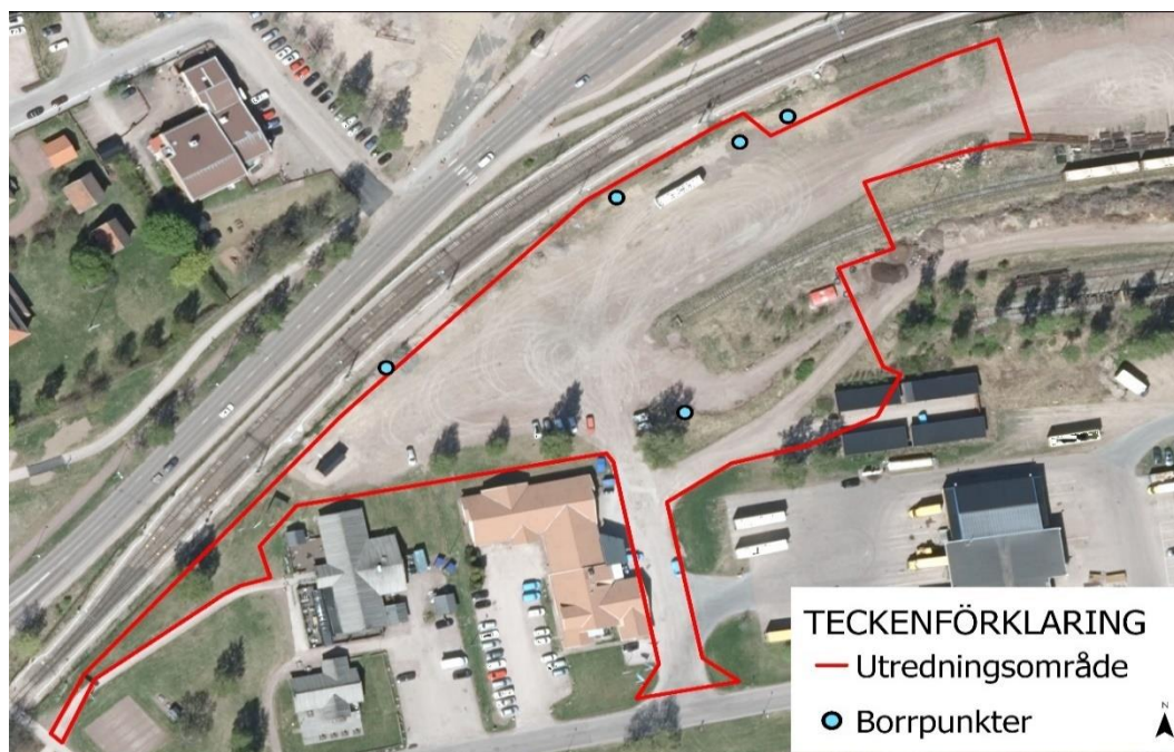
Figur 5. Placering av borrhpunkter vid den geotekniska fältundersökningen (AFRY, 2023a).
