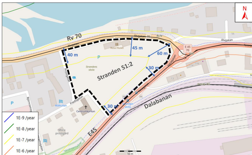
Figur 6-2. Individrisk från transport av farligt gods på de studerade riskkällorna. Gul konturkurva motsvarar acceptabel individrisknivån på 10^{-7} . De angivna avstånden ska mätas från väggkant.
