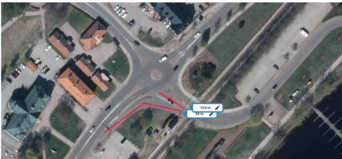
Bomfällning på Tingsnäs vägen och dess köutrymme vid svängfil och utfartsfil från Kaplans cirkulationen.
